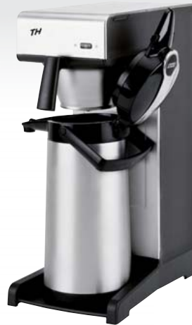
Kaffee- und Teebrühmaschine TH 10 ohne Wasseranschluss, ohne Isolierkanne. Ausgestattet mit Durch- lauferhitzer, Trockengeherschut, Temperaturbegrenzer, elektronischer Steuerung und Entkalkungsanzeige, komplett mit Filterpfanne. Stundenlei- stung 18 l / ca. 144 Tassen, Brühzeit (Wassermenge) 1,9 l - 6 Minuten, 2,2 l - 7 Minuten, Anschlusswert 230 V, 2.015 Watt, Maße B x T x H 205 x 335 x 547 mm
